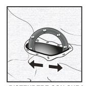
DISTENDERE CON CURA senza l'uso di attrezzi, al fine di passare la guarnizione con la controflangia nella cisterna
